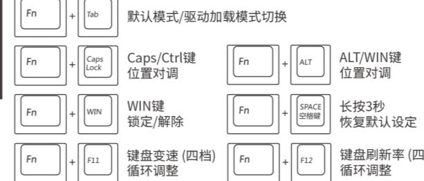
注：指示灯(ESC右侧)分别闪烁1、2、3、4次提示当前变速以及刷新率的档位设定。
